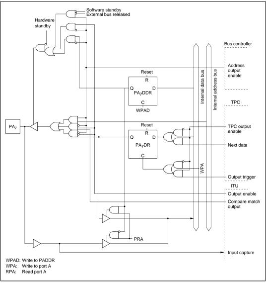
Figure C.10 (d) Port A Block Diagram (Pin PA<sub>7</sub>)
