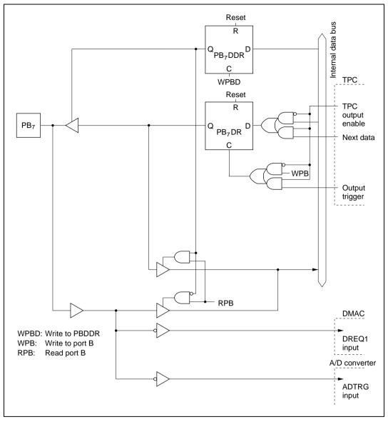
Figure C.11 (d) Port B Block Diagram (Pin PB7)
