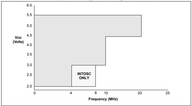
FIGURE 14-2: MAXIMUM OSCILLATOR FREQUENCY TABLE
